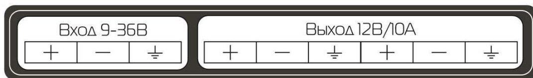
Рис.3 Подключение токоведущих кабелей
